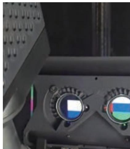
NED RX (処方) テスターは、シースルー画像の明瞭度と組み込まれた処方 AR スマートグラスを、量産向けに高い分解能と速度で測定することを目的に設計された、世界初の拡張
