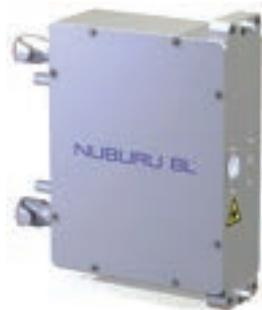
NUBURU BLは、金属3Dプリント用の標準的なスキャンシステムに搭載可能な、初めての高輝度青色レーザー製品ラインである。青色レーザーは、任意の材料加工レーザーと同様に、堅牢で簡単に再構成可能なシステムだが、青色レーザー加工の品質と速度は、他のどの波長よりも高い。以下で説明するように、その利点は、基礎物理学と効果的なシステム設計の両方に基づいている。当初は銅加工をターゲットとしていたNUBURUシステムだが、アルミニウム、ステンレス鋼、銀、金など、産業分野で用いられる他の金属にも、同じ利点を提供する。
