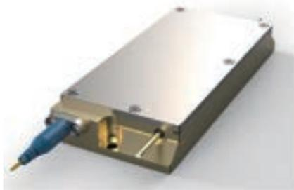
BWT社は、出力重量比2.3W/gの軽量波長ロックダイオードレーザ励起源を設計した。このレーザ励起源は、複数のチップ、複数の光学レンズ、ファイバなどで構成されている。ファイバ結合のコア径が105 $\mu$ m、開口数(NA)が0.22、電流が15A、中心波長が975.9nmにロックされた状態で、このレーザ励起源の出力は147.8Wである。電気光学パラメータによると、ファイバ外部の電気光変換効率率は52%、FWHM(Full Width at Half Maximum: 半値全幅)は0.5nmである。静的な熱シミュレーションによって光学パスが最適化されており、優れた放熱性に基づいて、最小限の機械構造が設計されている。
