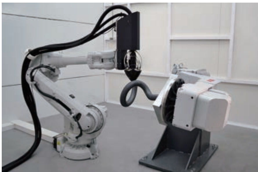
メルティオ社の堆積ヘッドは、複雑なフリーフォーム部品をプリントするためのロボティクスシステムに組み込まれる(写真提供:メルティオ社)
