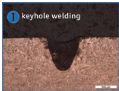
図3 波長が450nmの場合のレーザー溶接における断面図
