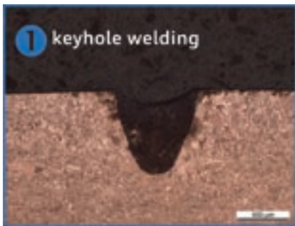
図3 波長が450nmの場合のレーザー溶接における断面図
