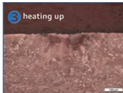
図3 波長が450nmの場合のレーザー溶接における断面図
