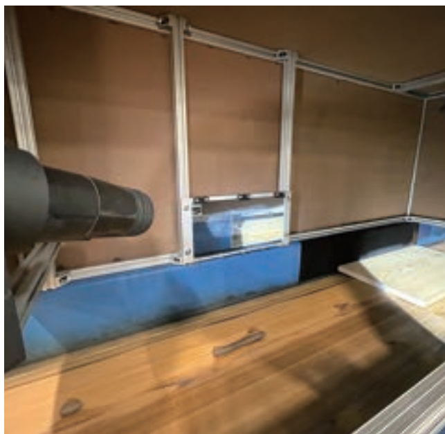
図1 Surface Finish Inspectorの筐体内部には、光経路を折り返すミラーが含まれている (写真提供: ポドキン社)
