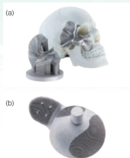
図1 積層造形によるチタン製コンポーネントは、生体医学用途に非常に適している。(a)は顔面用、(b)は腰ソケットのインプラント。
