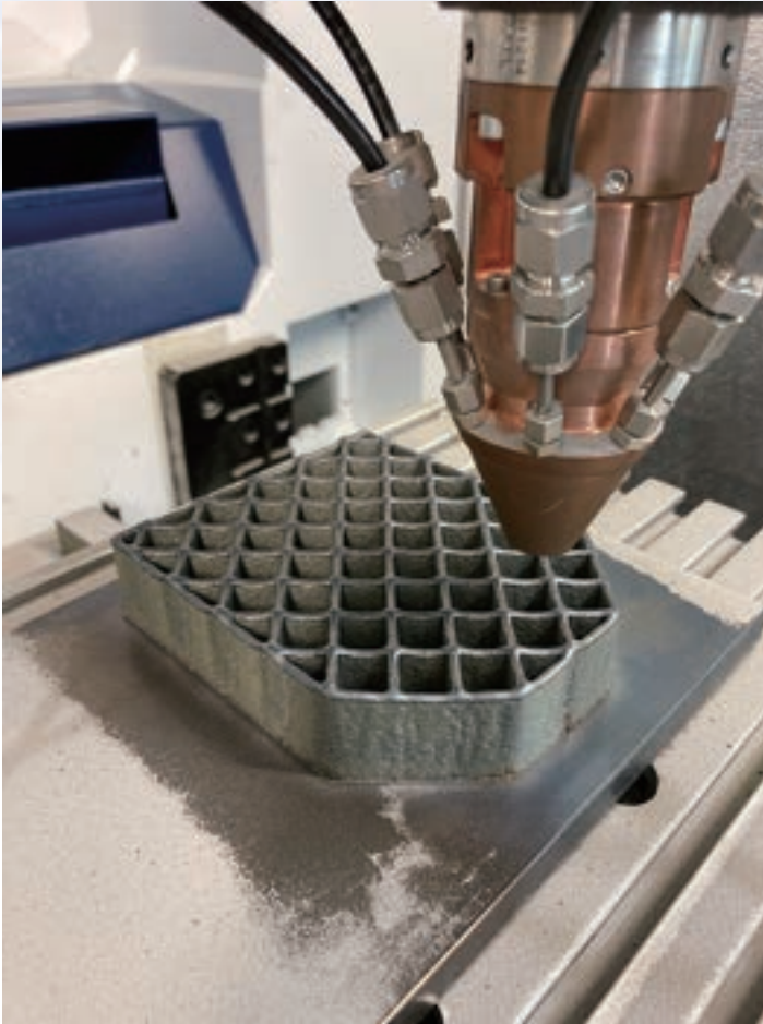
図3 レーザ金属堆積プロセスによって製造されたグリッドフィンのサンプル(写真提供: トルンプ社のウリ・クラスケ氏)
