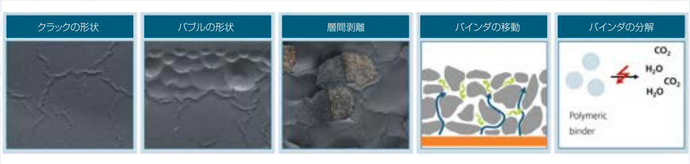
図2 陽極スラリーの高速レーザー乾燥
