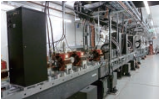
図4 SwissFELには、年中無休で稼働する横方向ビームプロファイル撮像装置が、定期的なモニタリング用に搭載されている (7) (写真提供:SwissFEL)
