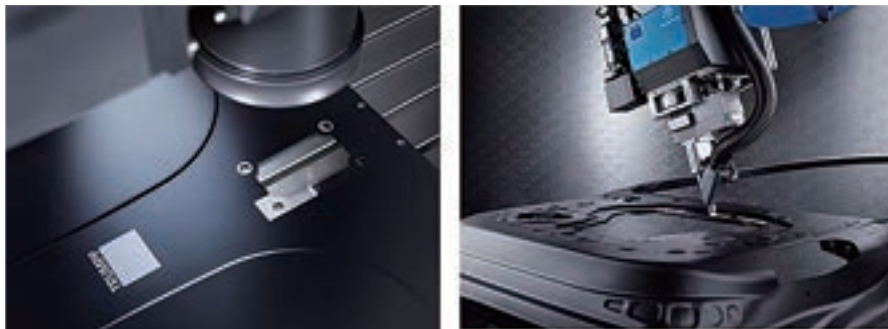
図3 局所抽出(右)付きのレーザーアブレーション(左)
