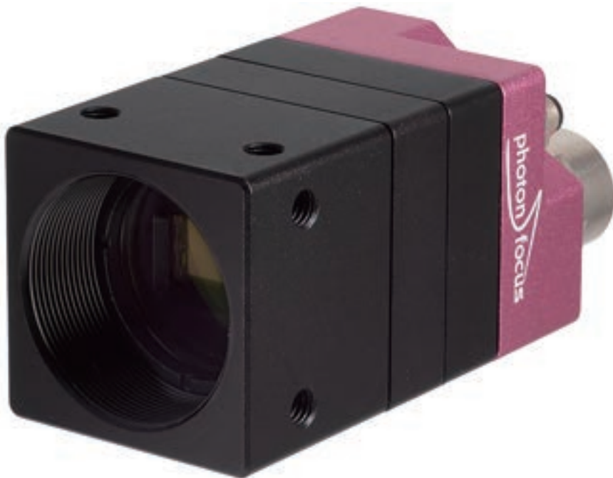
図2 フォトンフォーカス社製10GigEシリーズのハイパースペクトルカメラでは、毎秒1.1Gbitでの画像データ伝送が実現する
