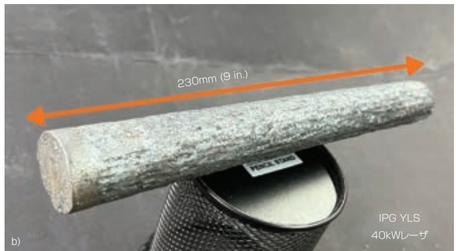
図4 UHPレーザを使用して非常に分厚い鋼材をパルスモードで切断した結果。(a)は、厚さ70mmのステンレス鋼に対する30kWでの窒素切断、(b)は、厚さ230mmの炭素鋼に対する40kWでの空気切断
