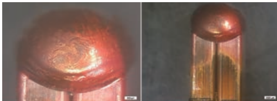
図2 断面積がそれぞれ9.9mm 2 の銅製ヘアピン材を、約250msで溶接した様子。
