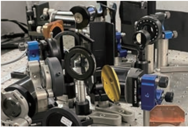
図2 コンパクトなテラヘルツ波の生成・検出装置の概要。これを用いると、生成したパルスの電界波形をストロボスコープで正確に検出できる。(画像提供:独レーゲンスブルク大 クリスチャン・マイネケ氏)
