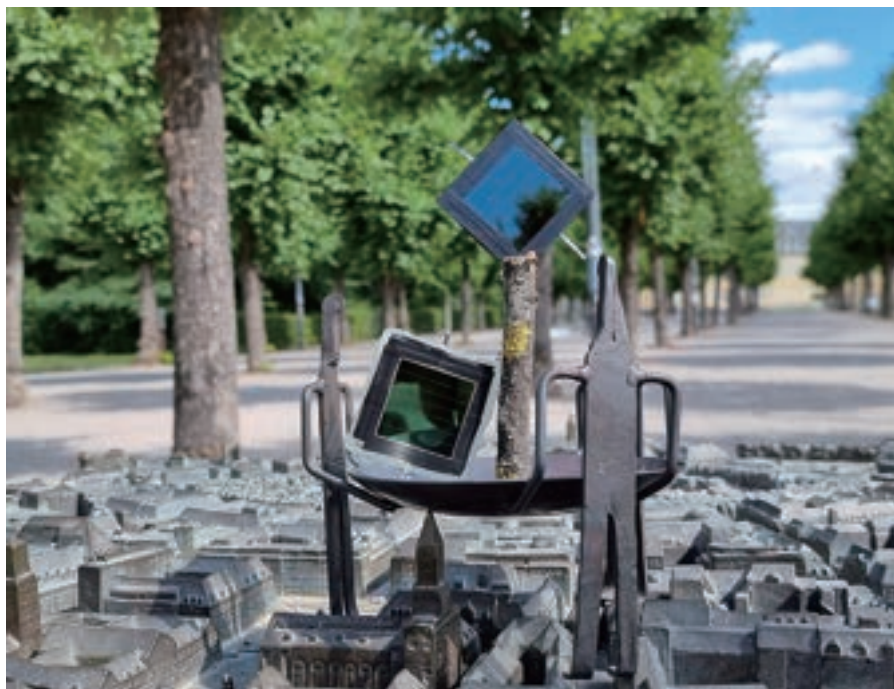
このオールペロプスカイトタンデムセルは、独カールスルーエ工科大 (Karlsruhe Institute of Technology) 研究者が完全スケラブルな成長法により作製した。(提供：パーラム・アブドラヒ・ネヤント氏)
