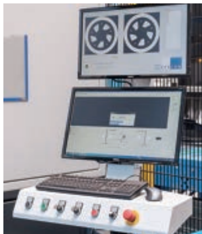
図3 部品の位置、向き、詳細を認識し、再現性の高い品質を保証するレーザービジョンシステム。
