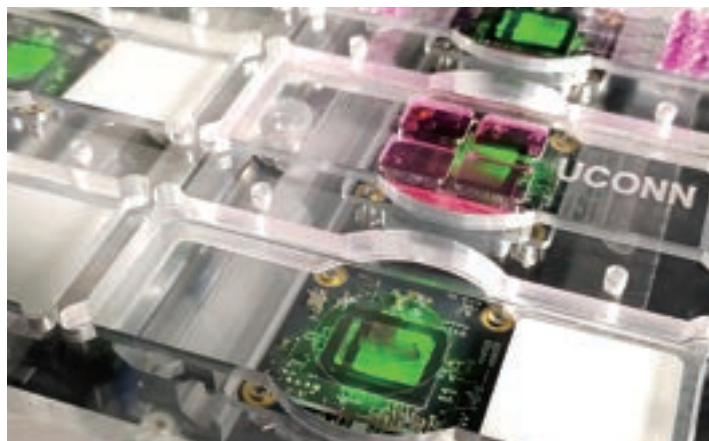
図2 並列コーディッドタイコグラフィのプロトタイプデバイス。
