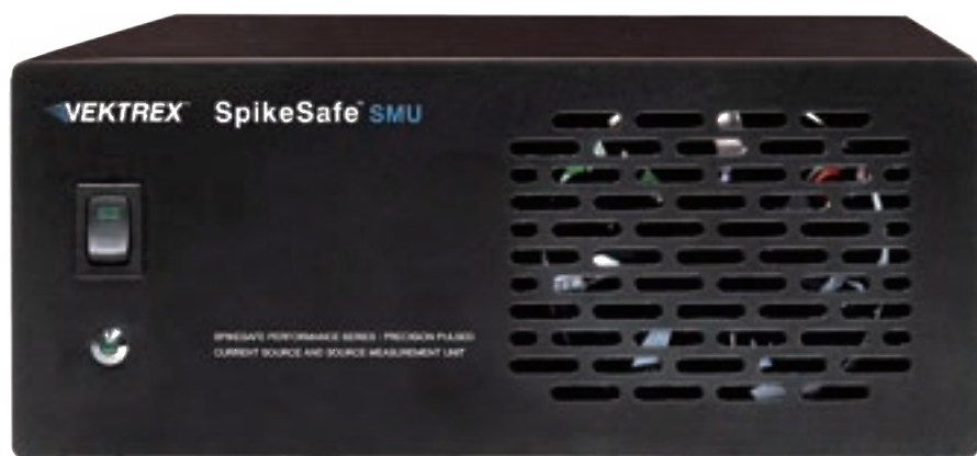
図1 1 \mu sに対応する第3世代SMUは、第1世代や第2世代のSMUとサイズは同じだが、短パルス試験方法において、より正確な測定結果を生成する (本稿の図はすべて、ベクトレックス社提供)。
