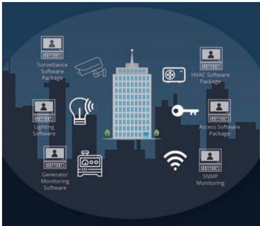
データと運用アクセスを保護するには、ビルネットワーク全体で共通して使用される複数のソフトウェア管理システムに対して、ネットワークアーキテクチャに組み込まれた厳格なセキュリティ制御が必要である。
