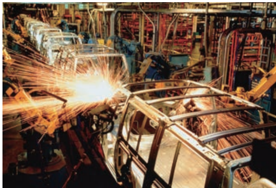
図4 ハイスピードカメラ「Falcon4-CLHS」を使用すると、車両組立ラインにおけるSUVフレームの溶接や溶接部の検査など、人間には物理的に困難な精密作業をロボットビジョンシステムで行える。(提供：テレダイン・ダルサ社)
