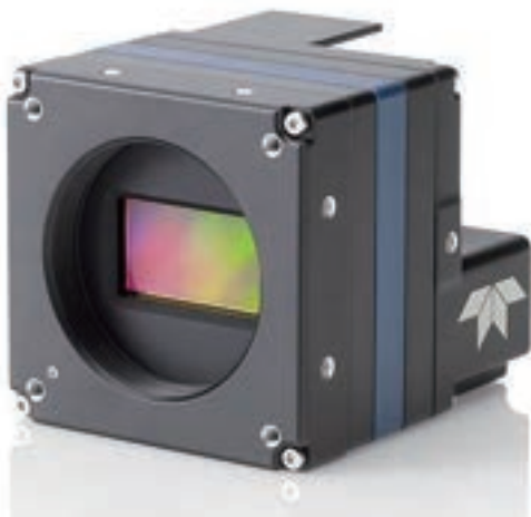
図3 高フレームレートカメラ「Falcon4-CLHS」は、最大4480ピクセル、2496ラインの大視野と609fpsのフレームレートを実現し、超高速・超解像の産業オートメーション検査において重宝される。(提供：テレダイン・ダルサ社)
