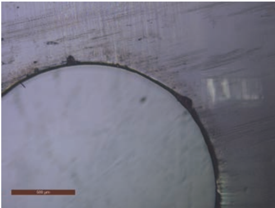
図3 炭素繊維複合材のこの2mmの穴は、周囲のエポキシ樹脂に熱損傷をほぼ与えることなくあけられている。
