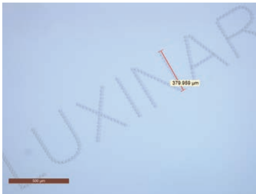
図1 フェムト秒レーザー光源を使用して、高さが0.5mm未満の文字をガラスの表面下にマーキングすることができる。
