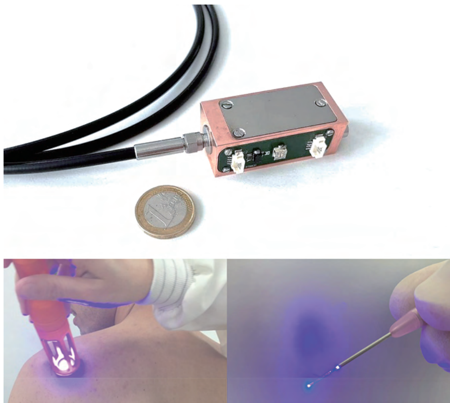
図1 レーザー治療デバイスのコア技術はダイオードレーザーに基づいている。他にはない出力や波長の拡張性があり、幅広い医療用途に利用されている。
