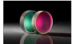
超短パルス極端紫外 (EUV) システムは、自由電子レーザー (FEL) などの量子光学アプリケーションにおいて重要性を増している。UFI EUV アト秒多層膜ミラーは、アト秒パルスのステアリング、集光、整形用にデザインされている。その多層膜コーティングは、65eV (19nm) を中心にして 6eV (1.8nm) のバンド幅を持ち、s 偏光の光に対して 38% のピーク反射率が得られる。このミラーは、330 アト秒の持続時間を持つ EUV パルスに対応し、高次高調波発生 (HHG) に基づくアト秒パルス生成や整形に理想的。
