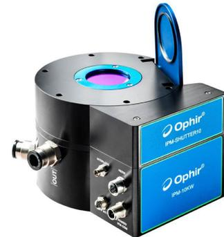
IPM-10KW センサーは、900~1100nm および 10.6 $\mu$ m の波長で 100W~11kW の出力を測定します。このセンサーは、切断および溶接用のレーザーをベースにした機械のメーカー、およびこれらの機械を使用して部品を製造するユーザー向けに設計されています。センサーのモジュラー形式により、ユーザーはアプリケーションのニーズに基づいてコンポーネントを組み合わせることができます。現場交換可能なウィンドウを備えたオプションの自動シャッターは、ほこりや破片からセンサーを保護します。オプションの通信モジュールは、Profinet または EtherNet/IP 接続を提供します。
