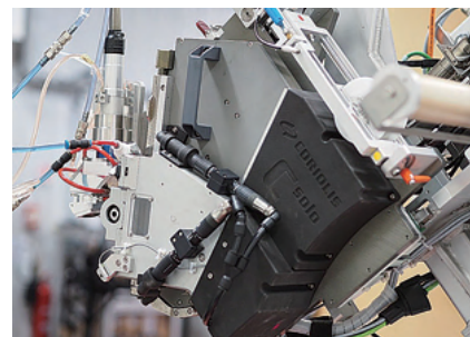
図2 カイルラズ社の繊維配置ヘッド (左側) を搭載した「Coriolis C-solo」のロボットアーム。
