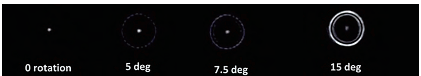
図1 回折光学素子(DOE)プレートの互いに対する相対的な回転角度による、強度分布の変化。
