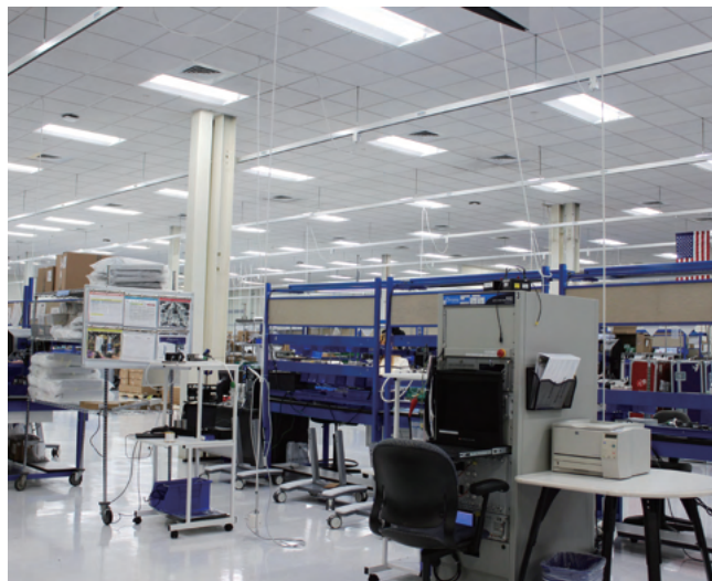
図2 産業環境において、照明は、さまざまな作業エリアの機能を考慮して、慎重に選択されて設置される。写真には、2つの異なるピッキングステーションが示されている。ハイエンドなトリム照明が、大きな品物を扱うステーションでは低い位置に設置されており、小さな品物を扱うステーションでは高い位置に設置されている。人間の目では違いが分かりにくい、エネルギー効率の向上という結果が得られている。
