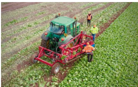
(図: Agri-Epicentre (英国) のプロトタイプのレタス収穫ロボット)
