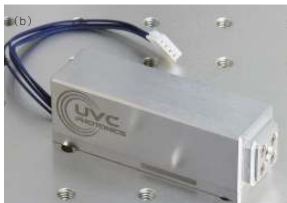
図1 深紫外レーザーは、青色励起ダイオードレーザー、プラセオジウムレーザー結晶、第2高調波発生 (SHG) 結晶、共振器出力ミラーで構成されている (a)。これによって、非常にコンパクトなデバイスが完成した (b)。
