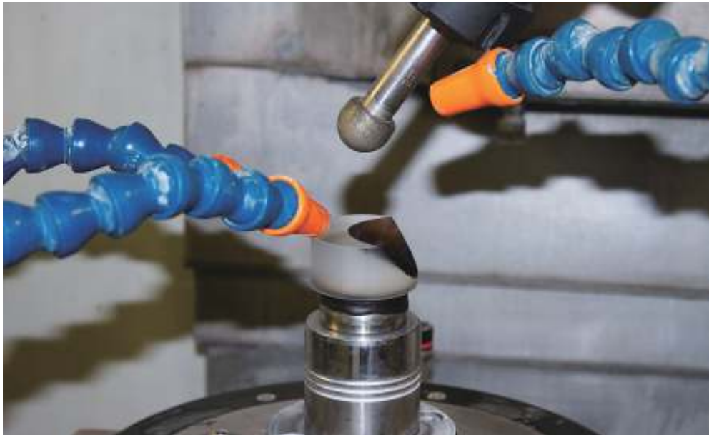
図2 ボール工具を使用して、楕円体の表面を粗／微細研削した。処理の前に表面は黒いマーカで覆われていた。これは、光学部品の研削及び研磨時において、表面全体にわたって確実な材料除去を確保するために一般的に行われる。
