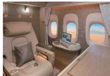
図5 ローゼン社が「Emirates 777-300ER Game Changer」のセンターシートに提供したバーチャルウィンドウ。(提供: エミレーツ航空[Emirates])
