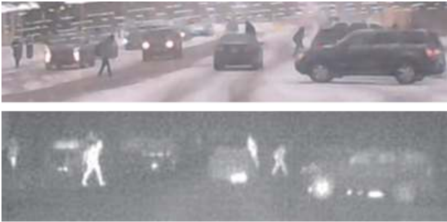
図2 IRがどのようにビジョンカメラに情報を追加するかを示す例。(上の画像):ビジョンカメラで撮影した冬のシーン。(下の画像):IRスペクトルで示されているのと同じシーン。歩行者、車輪、排気管に注目。
