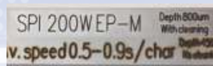
図1 200Wの「EP-M」レーザによるVINマーキングの例。
