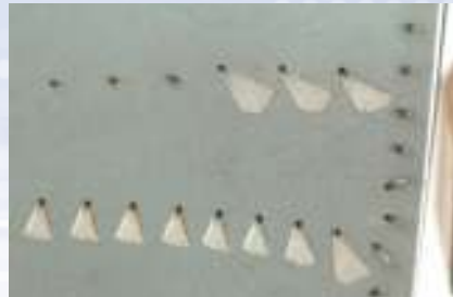
図7 超合金からの遮熱コーティングの選択的除去。(提供:英ウィンプロ・グループ・テクノロジーズ社[Winbro Group Technologies])
