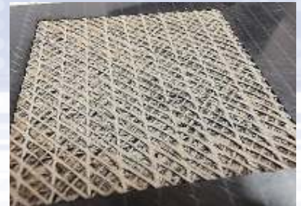
図8 炭素繊維強化プラスチック(CRP)の選択的材料除去。
