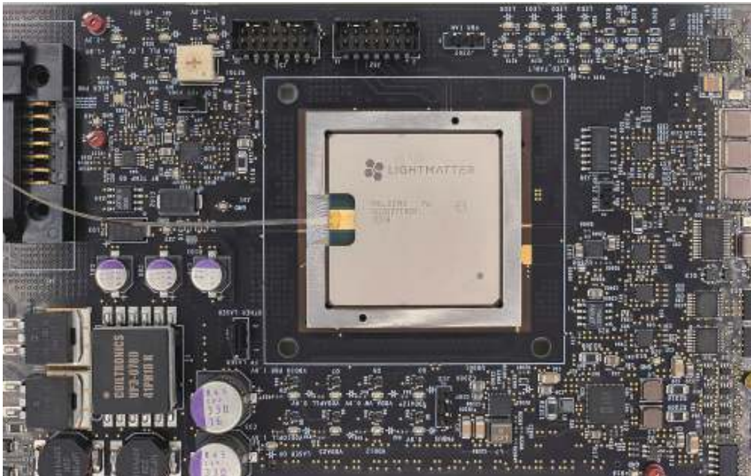
図3 Envisieシステムの内部。中央の金属ケースにフォトニックプロセッサが収まっている。
