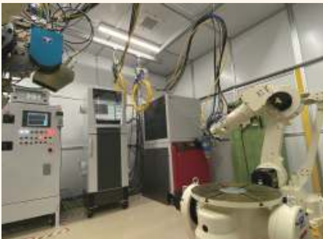
図1 デモンストレーションに使用された切断、溶接システム。右端が多関節6軸ロボット、その先端にモニタリングヘッド(WeldMaster)、及び切断加工ヘッド(SolidCutter)を装着。その背後に設置されているのが、右端にレーザーラインコンバータレーザ(LDF 8000-6)、その隣がプレシテック社のコントローラ、さらにその左が全体をコントロールする豊電子工業の制御システム。
