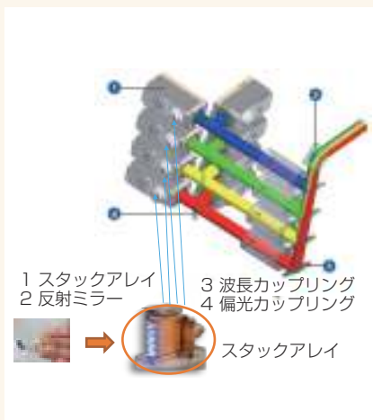
図3 ダイレクトヘッドレーザーの高出化。半導体レーザーチップをヒートシンクに実装し、それをスタックアレイにする。そのアレイを複数個並べて高出化。さらに、偏光/波長カップリングを利用する。(提供:レーザーライン社)
