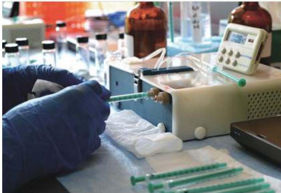
図3 アフィニティ・インストゥルメント社のポータブルSPRシステムであるP4-SPR(同社提供)。
