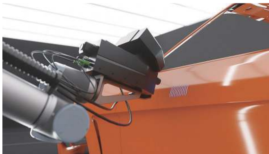
テラヘルツ放射を利用して膜厚測定を行うマルチセンサヘッド。(画像提供: 独ヘルムート・フィッシャー社 [Helmut Fischer GmbH])
