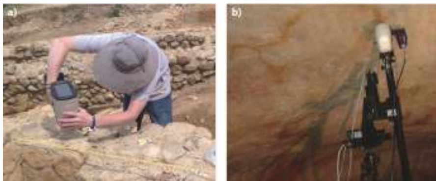
図3 さまざまな遺跡での分光分析。(a)イタリアのオルヴィエートにあるセントアンセルム大フィールドスクールによるハンドヘルドLIBSでの壁モルタル分析。(b)スペインのカンタブリアにあるクバエルカスティヨでのポータブルラマン顕微鏡による先史時代の洞窟壁画の分析(著者の許可を得て掲載)。
