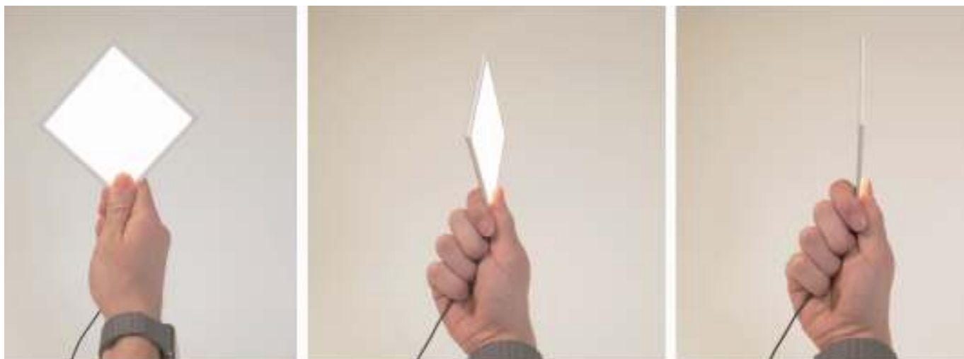
図2 薄型の形状、グレアのない拡散光、高い色品質という、OLEDの望ましい性質に着想を得て考案された、新しい平面状のLEDライトガイドに基づくモジュールは、OLEDと同等の性質を備えつつ、それよりも効率的な性能を発揮する。(写真提供: エームスコ・ライティング社)
