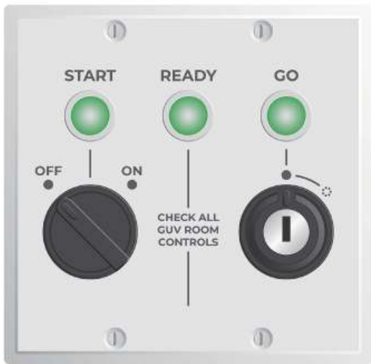
図2 クーパー社の「GUV User Station」は、占有センサからの入力に加えて、権限のある担当者が鍵でシステムを解除しなければ、殺菌サイクルを開始するスイッチが操作できないようになっている。(写真提供:クーパー・ライティング・ソリューションズ社)
