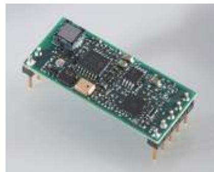
図3 AmbiMateのようなコンパクトで簡単に入手可能なセンサモジュールは、複数の環境センシング機能が1つのデバイスに搭載されており、市場投入期間の短縮と設計フォームファクタの縮小に貢献する。
