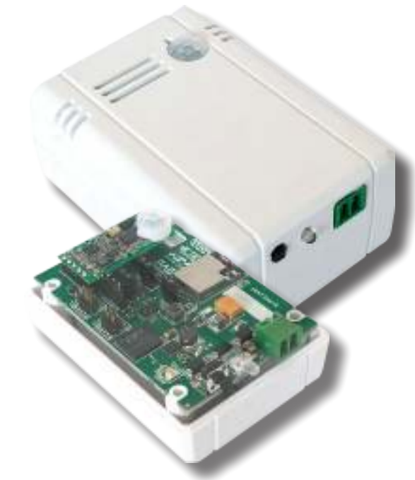
図4 ディストリビューターのアロー・エレクトロニクス社は、TEコネクティビティ社のAmbiMateセンサを活用して、「Sentimate」というワイヤレスセンサ装置を構築した。ワイヤレス機能とバッテリー部品が搭載されており、製品開発者が柔軟に組み合わせて使用できる製品となっている。
