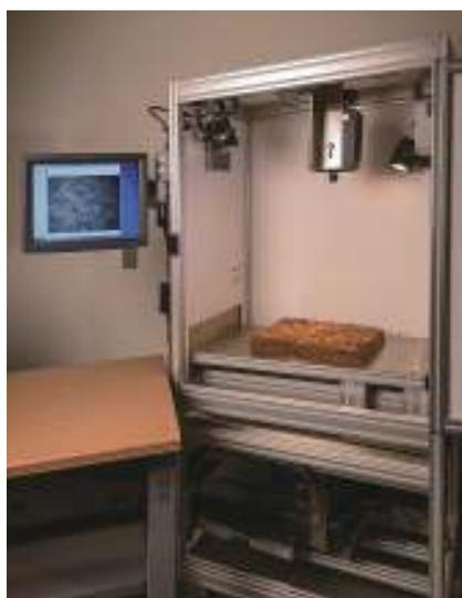
図1 タバコ葉ブレンド等級検証システムは、筐体、タングステンハロゲンランプ、冷却ファン、及びハイパースペクトルカメラで構成される。
