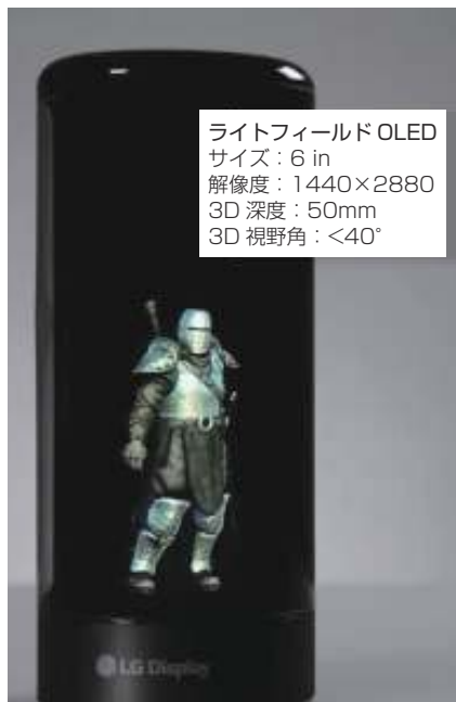
図8 スマートスピーカー内のライトフィールド3Dディスプレイ。(画像提供:LGディスプレイ社)
