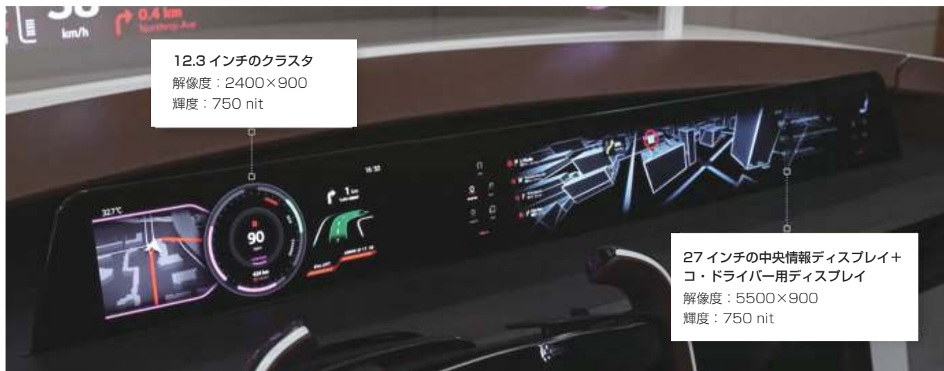
図7 曲面OLEDディスプレイを採用した自動車コックピットのコンセプト。(画像提供:LGディスプレイ社)
