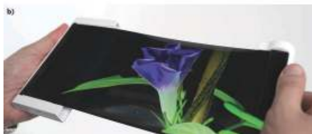
図2 13.3インチの折りたたみ可能なノートPC用ディスプレイ。(画像提供:LGディスプレイ社)
