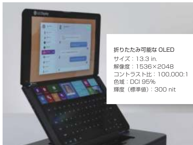
図2 13.3インチの折りたたみ可能なノートPC用ディスプレイ。(画像提供:LGディスプレイ社)
