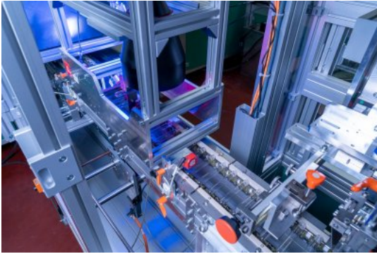
画像 (© IDS Imaging Development Systems GmbH): マルチカメラシステム "VialChecker" はワクチン容器の品質管理を高速で処理できます。© Isotronic GmbH
