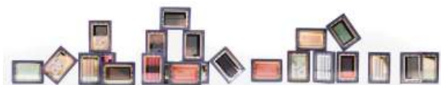
図1 これらのハイパースペクトル(HS)イメージングセンサは、CMOSベースのチップ技術によって製造されている。(画像提供:imec)
