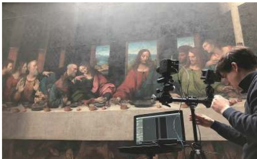
図2 小型HSカメラによって、ダ・ヴィンチの「最後の晩餐」の複製画を150のスペクトルバンドで撮影した。(画像提供:imec)
