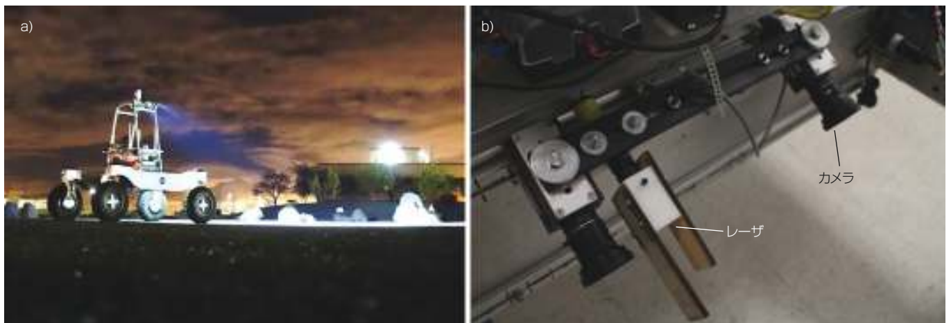
図1 実験はNASAのK-REX2ローバーを使用して行われた。ここでは、ローバースケープでの夜間テストを示している(a)。仮想バンパーのセットアップは、ローバーの前縁に取り付けられたマルチドットレーザプロジェクトとカメラから構成される(b)。
