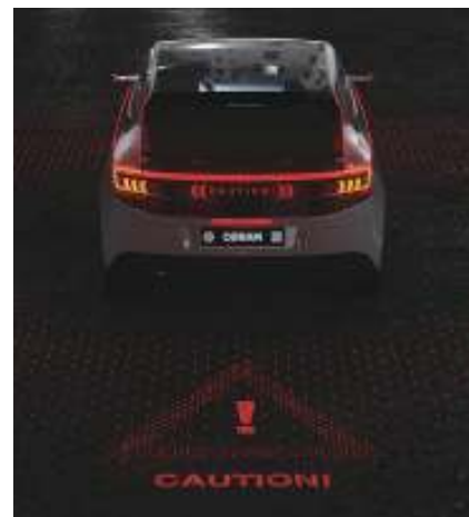
図3 自動車外装用のLED照明は、プログラム可能なカスタムデザインを可能にするとともに、安全メッセージを発することができる。オスラムオプトセミコンダクターズ社のリアコンビネーションライト(RCL)技術を示す、このコンピュータ生成画像は、その一例である。(画像作成・提供:オスラムオプトセミコンダクターズ社)
