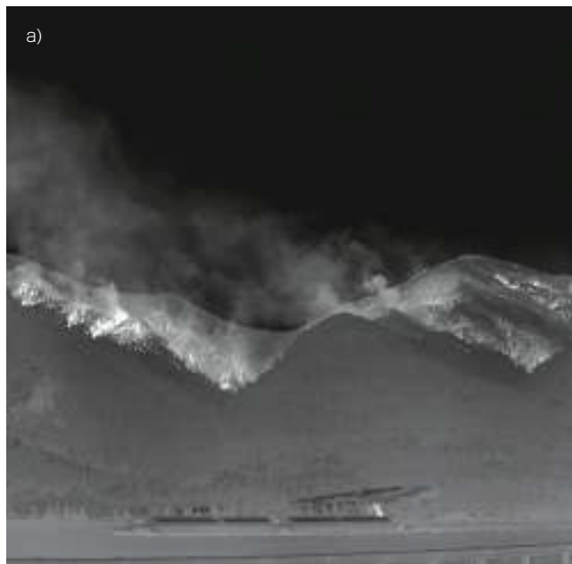
図6 (a)シエラオリンピック社のLWIRカメラで撮影した、2017年にオレゴン州で起きたイーグルクリーク火災の画像には、火災発生地点がはっきりと示されている。(b)は、同じ場所のLWIR画像と可視光画像を比較したもので、煙の向こう側を撮影するLWIRの能力が見てとれる。(画像提供:シエラオリンピック社)
