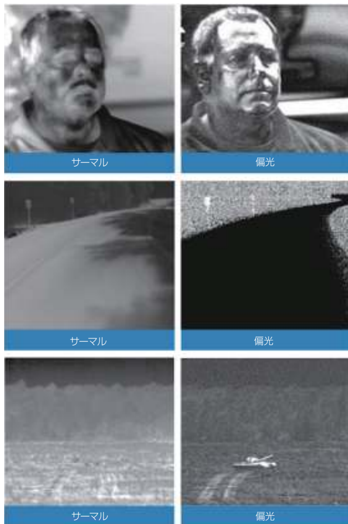
図7 従来のLWIRサーマルカメラ(左)とポラリス社の偏光ベースのLWIRカメラ「Pyxis」(右)で撮影したさまざまな画像の比較。1)顔認識(上):偏光を利用するサーマルイメージングでは、形状の微妙な変化をとらえて、顔の特徴を分析する。2)自動運転車のナビゲーション(中央):サーマル画像ではコントラストが低かったり、影で紛らわしかったりする場合でも、偏光を利用すると、車道、障害物、遠くにある他の車両を簡単に識別することができる。3)標的検出(下):偏光に特殊なソフトウェアを組み合わせることにより、煩雑な背景を除去しつつ、サーマル画像ではほとんど見えない軍用車両などの脅威を検出することができる。(画像提供:ポラリスセンサテクノロジーズ社)
