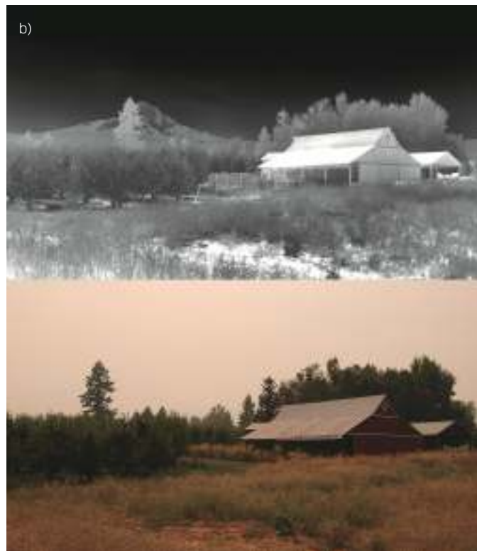
図6 (a)シエラオリンピック社のLWIRカメラで撮影した、2017年にオレゴン州で起きたイーグルクリーク火災の画像には、火災発生地点がはっきりと示されている。(b)は、同じ場所のLWIR画像と可視光画像を比較したもので、煙の向こう側を撮影するLWIRの能力が見てとれる。(画像提供:シエラオリンピック社)
