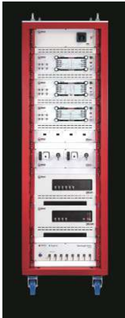
図4 量子アプリケーションにおけるコンパクトでロバストなレーザーソリューションの要求に応えるため、トプティカフォトニクス社はモジュール式レーザーの19インチラックシステムを開発している。ラックシステムは、狭線幅の波長可変ダイオードレーザー、増幅・周波数倍増レーザーシステム、周波数コム、波長計、その他のコンポーネントから構成される。デジタルレーザーコントローラは、レーザーモジュールの遠隔制御と、アプリケーションの制御ソフトウェア(例えばPythonソフトウェア開発キットの使用)との深い統合を可能にする。
