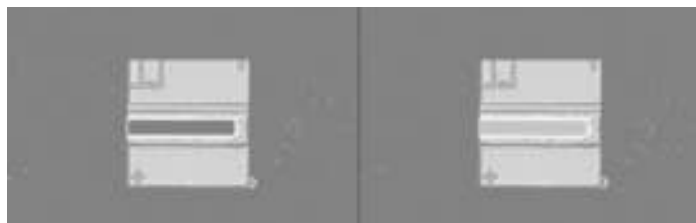
図3 CoSのボイド実験において、接合後のボイド率は、MIL-STD 883KのMethod 2030.2の仕様を上回り、それよりも厳しいHPLDのボイド率の仕様も満たした。
